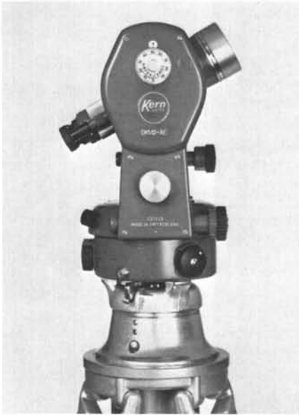
Abb. 1 DKM2-AM mit Kippachsmikrometer. Der Mikrometerknopf der Skala befindet sich am Deckel zum Gehäuse des Höhenkreises. Die Skala ist in Intervalle von 1" (sexagesimal) geteilt.
