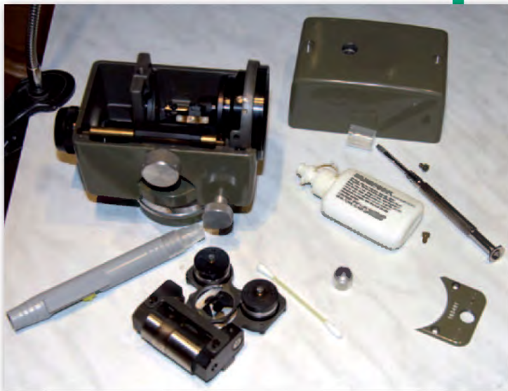
Rys. 7. Rozmontowany niwelator GK1 A z magnetycznym kompensatorem na pierwszym planie
