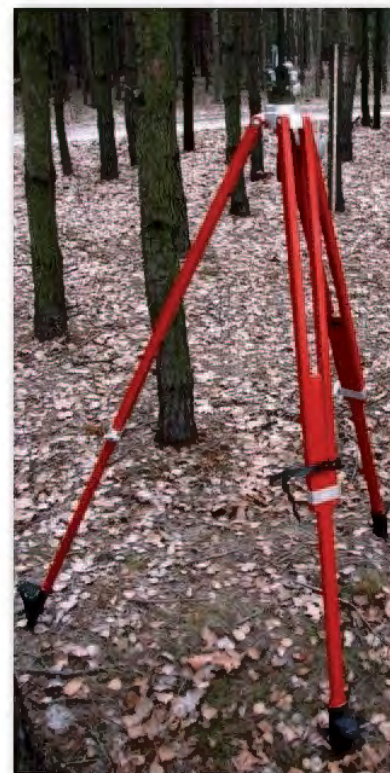
Rys. 2. Statyw po renowacji
