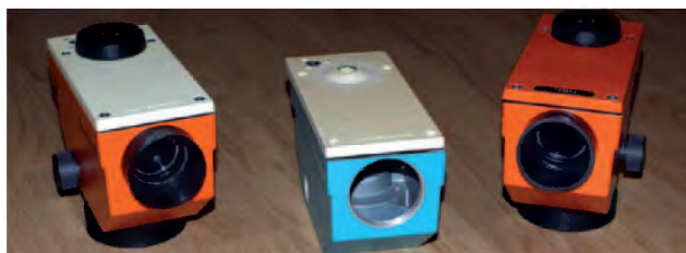
Rys. 9. Kolejne fazy upiększania niwelatora Kernlevel. Wnętrze fabrycznie nowej obudowy z napisem Leica zappełniły elementy dwóch innych egzemplarzy z nieco zmęczoną życiem obudową
