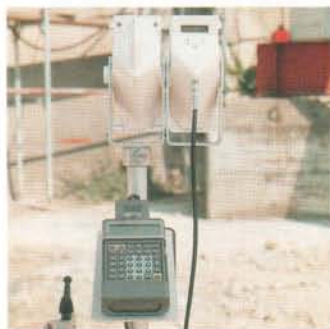
Mit einem klemmbaren Halter ist der PSION am Reflektorstock befestigt. Ein Kabel stellt die Verbindung zum RD 20 her.
