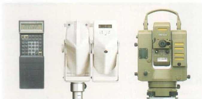
Ausrüstung für die Feldmessung: Der Tachymeter E12 oder E2 mit DM 504 oder DM 503 ermittelt die Messwerte und sendet sie auf dem Messstrahl des Entfernungsmessers zum RD 20, wo sie vom Feldrechner übernommen werden.
