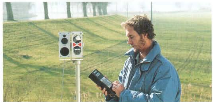
Detailpunktaufnahme mit Kern ALPHACORD. Über den RD 20 können sämtliche Messwerte von jedem Feldrechner mit RS 232-C-kompatibler Schnittstelle und der entsprechenden Software abgerufen werden.
