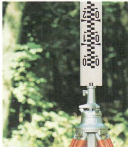
Tachymeter-Kurzlatte aus Leichtmetall, Länge 1,2 m, mit Lattenfuss, zum Aufsetzen auf alle Kern-Zentrierstative, für den Tachymeter-Theodolit K1-RA
