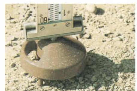
Bodenplatte zum Aufstellen der Invarmiren gewährleistet eindeutig definierte, unveränderliche Standpunkthöhe.
