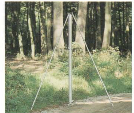
Mirengestänge aus Leichtmetall, zum sicheren Aufstellen der Invarmiren. Länge der Streben mit Friktionsgriffen bequem verstellbar. Mit umgekehrten Ziffern (für GK23) und aufrechten Ziffern (für GK23-E).
