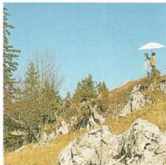
Tektonische Vorgänge werden über längere Zeit mit dem Mekometer auf Bruchteile von Millimetern genau erfasst.
