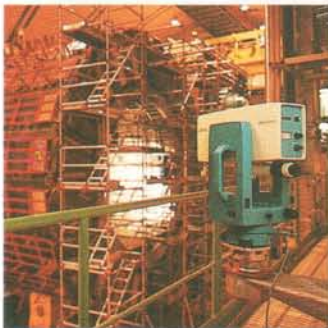
Das Mekometer ermöglicht Montage-, Justier- und Kontrollarbeiten in der Industrie mit höchster Präzision.
