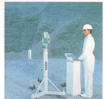
Computer-Programme steuern den Messablauf und erweitern gleichzeitig den Anwendungsbereich des Mekometers.
