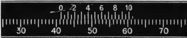
Fig. 2 Lattenbild durch das Fernrohr gesehen, bei richtig aufgesetztem Doppelbildprisma. Ablesung 41,35 m.
