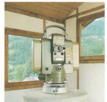
Geschützt vor atmosphärischen Einflüssen misst der E2-ST automatisch Entfernungen und Richtungen zu Zielen im Rutschgebiet.
