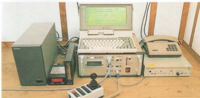
Software im Computer richtet den Tachymeter auf die Ziele aus und speichert die Messwerte sowie Temperatur und Druck. Über Telefon und Modem kann die Station jederzeit abgefragt oder zu Messungen veranlasst werden.
