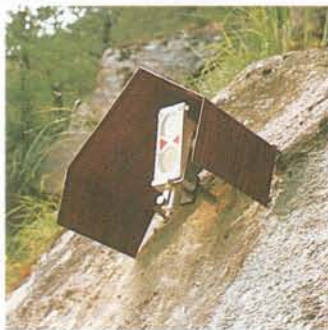
Die ständige Vermarkung der Zielpunkte ist gegen Witterungseinflüsse geschützt.
