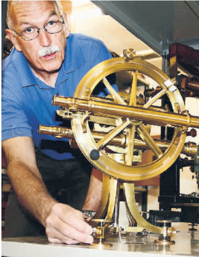
Ein Prunkstück in der Sammlung: Hansjörg Schneeberger zeigt den Borda-Kreis für die erste trigonometrische Vermessung der Schweiz durch General Dufour.
