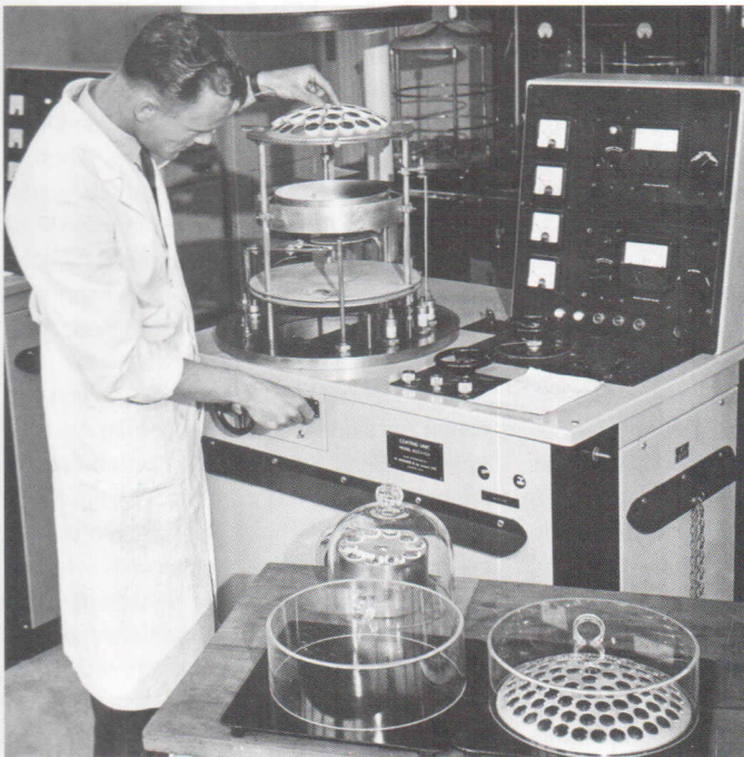
Anlage zum Aufdampfen von Antireflex-Belägen auf Linsen und Prismen. Die Anlage stammt aus den Jahren um 1950.
