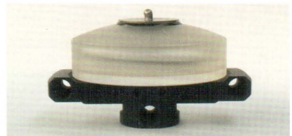
Abb. 3: Die Kompensator-Dose aus Glas mit einem Teil der Abbildungsoptik (unten) und dem Einfüllstutzen für die Flüssigkeit (oben).
