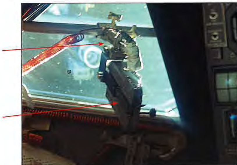
Abb. 5: Am Fenster der Mondlandefähre montierte DAC Pfeil oben: Haltegestänge Pfeil unten: Filmkamera
