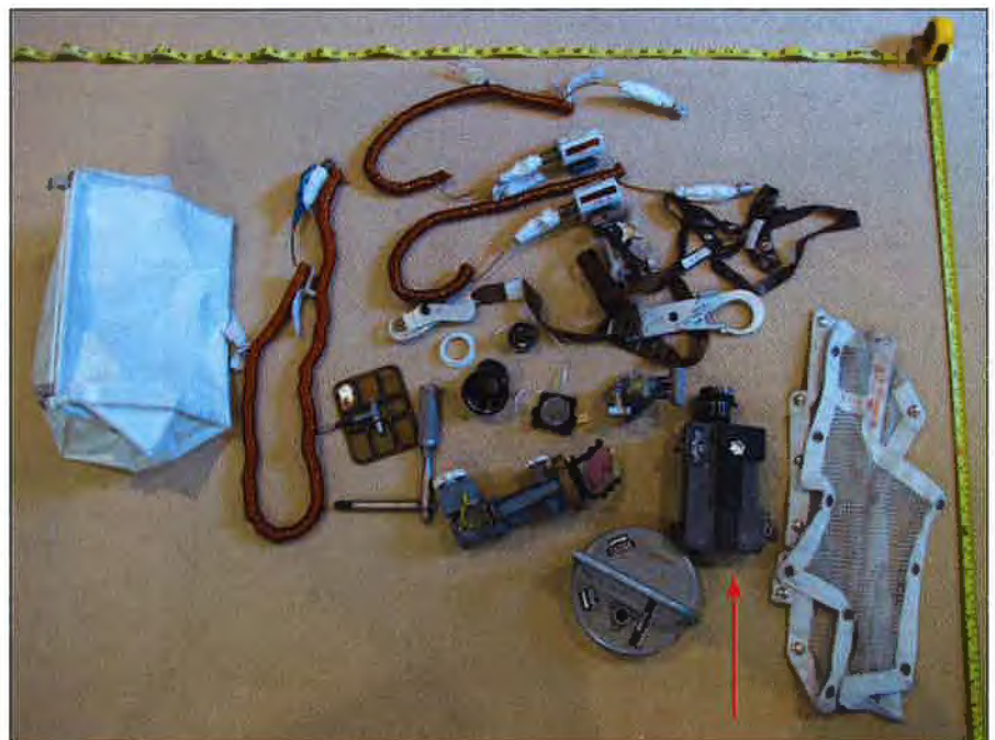
Abb. 2: Der Tascheninhalt. Der Pfeil weist auf die DAC-16mm-Filmkamera mit einem 10mm Objektiv von Kern
