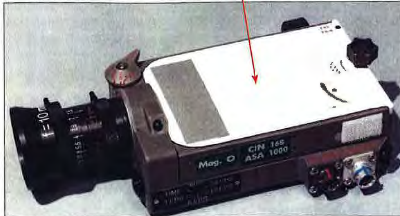
Abb. 4: Die Maurer-DAC 16mm-Filmkamera mit eingesetzter 140 feet (43 m) Filmkassette (Pfeil)
