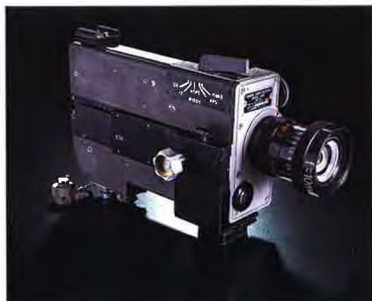
Abb. 3: Die Maurer-DAC-16 mm-Filmkamera mit dem 10 mm-Kern-NASA-Objektiv
