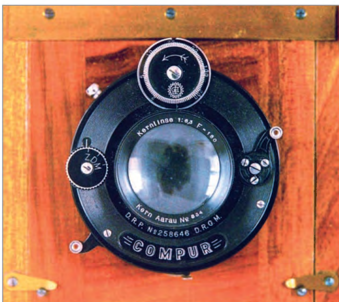
Abb. 22: Frey-Holzkamera, Detail-Abbildung der Kernlinse 6,3/180 in Compur-Verschluss
