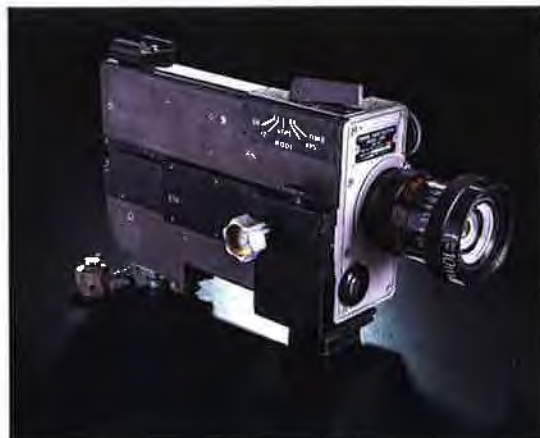
Abb. 3: Die Maurer-DAC-16 mm-Filmkamera mit dem 10 mm-Kern-NASA-Objektiv
