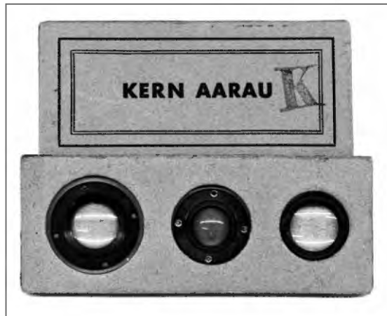
Abb.20: Versandschachtel mit den drei Linsen, davon eine verkittete Doppellinse, für die Compass
