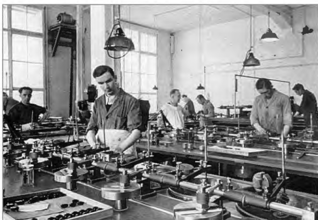
Abb. 4: Teilansicht des Optik-Poliersaales im Werk Schachen
