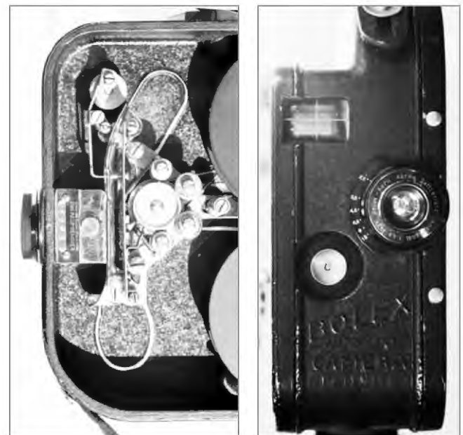
Abb. 25a und b: links ein Blick ins Innere der von Jaques Bogopolski konstruierten und von Bol S.A., Genf hergestellten 16mm-Filmkamera Bolex Auto Cine ; recht erkennt man in der Frontalansicht, dass die Kamera mit einem Kern-Objektiv Anastigmat 2,5/25 mm ausgerüstet ist.
