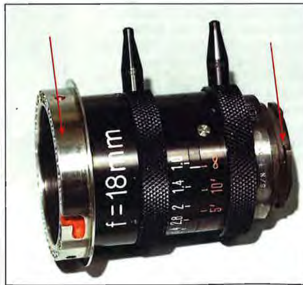
Abb. 6: Das Kern-18 mm Objektiv mit montierten Bajonettverschluss-Adaptern Pfeil links: Bajonettverschluss für den Right Angle Mirror Pfeil rechts: Aufgeschraubter Bajonettverschluss zur DAC
