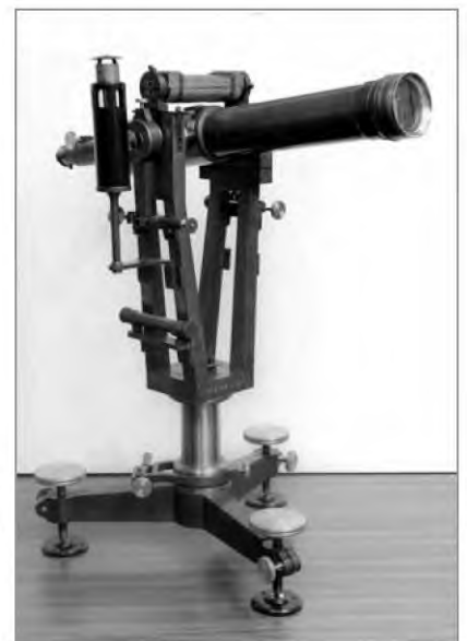
Abb. 2: Großer Kern Absteck-Theodolit, eingesetzt beim Bau des Simplon-Eisenbahntunnels (1898-1905)
