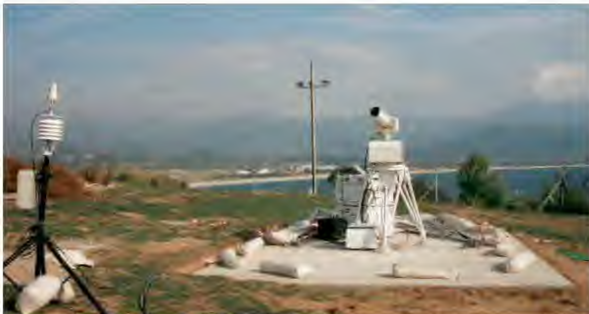
Figure 2.4 : La Station Laser Ultra Mobile à Ajaccio au cours de la campagne en Corse (1997). On peut distinguer sur la gauche la station météorologique et l'antenne GPS. L'ensemble du reste de l'instrumentation se trouve sur la droite. La tente protectrice est repliée au sol à l'arrière de la station.
