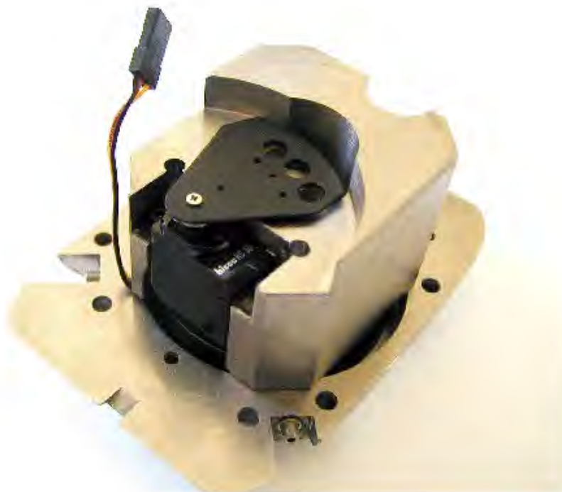
Figure 2.20 : Système rotatif de densités optiques placé dans la tourelle devant la C-SPAD.
