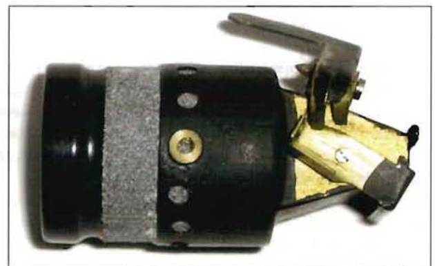
Abb. 20b: Das Objektivrohr; Verschluss offen
