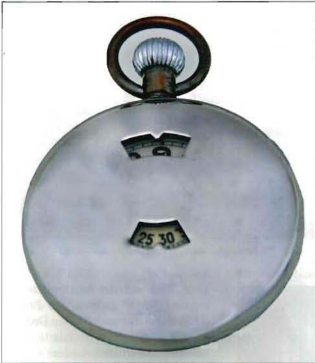
Abb. 4: Michel Taschenuhr von 1925. Die Stunden wurden im oberen, die Minuten im unteren Fenster angezeigt.
