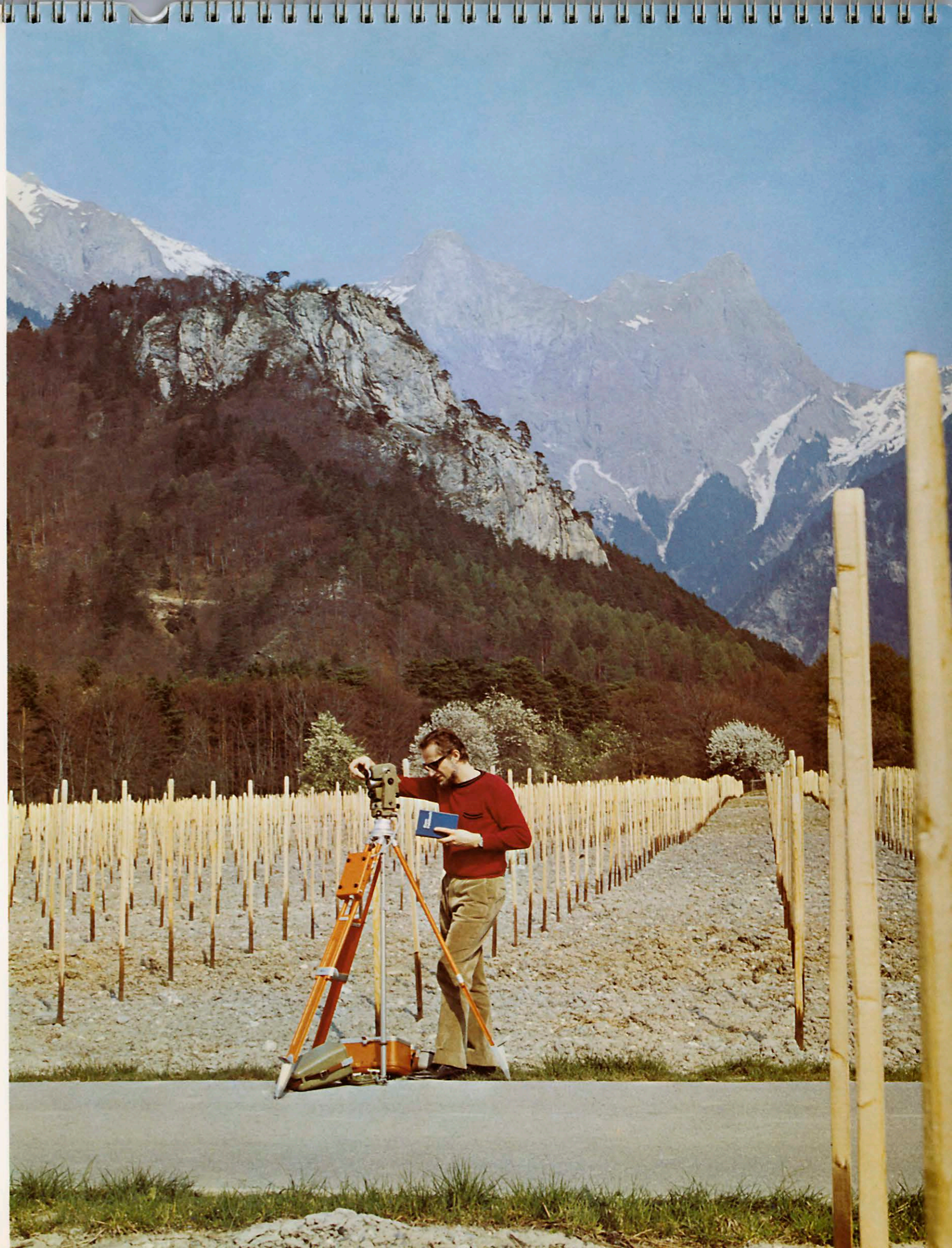
Katastervermessung in einem Rebberg bei Fläsch (Graubünden) mit dem Ingenieurtheodolit Kern K1-S und dem damit kombinierten elektrooptischen Distanzmessgerät Kern DM 500
