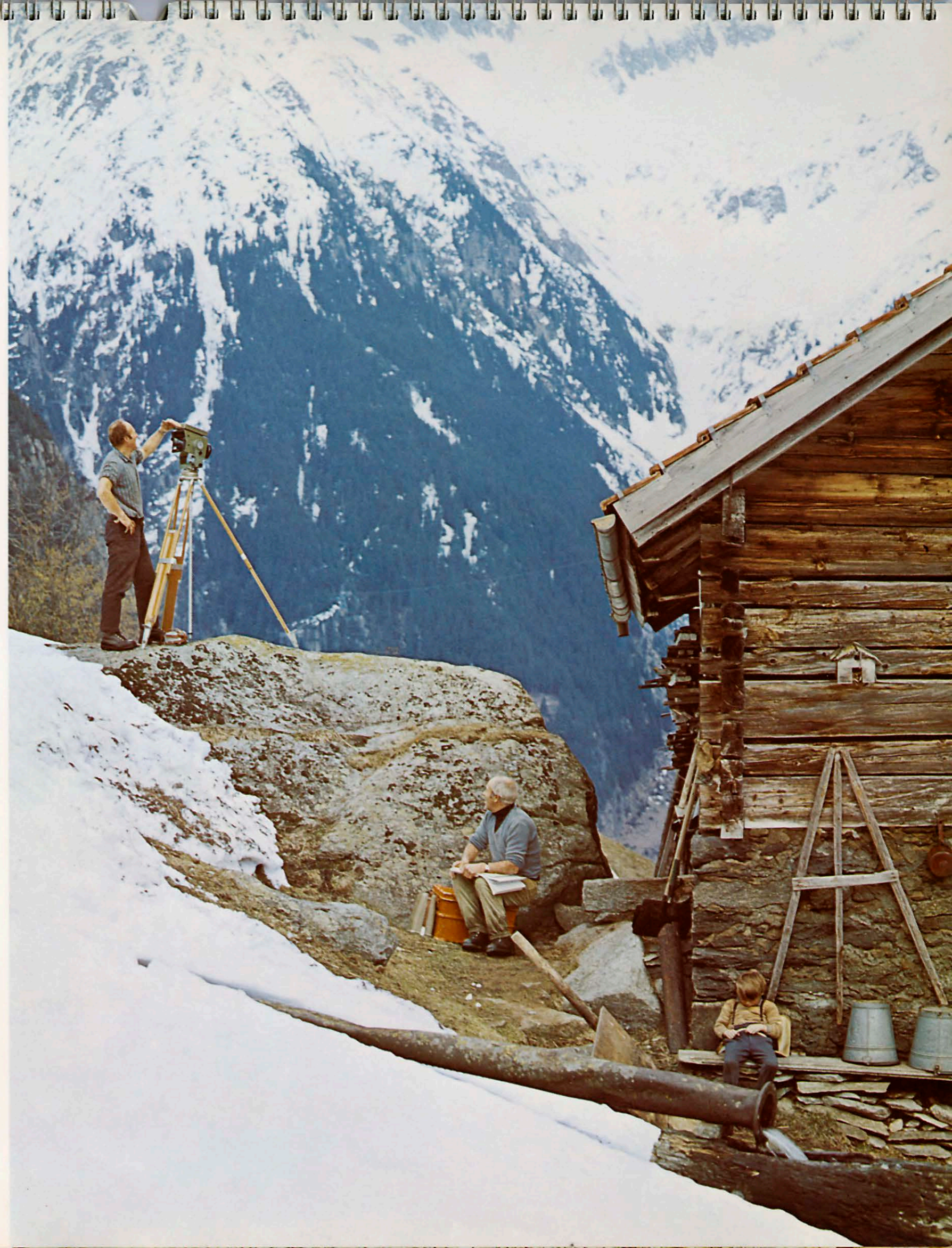
Verdichtung eines Festpunktnetzes bei Göschenen (Uri) mit dem elektrooptischen Distanzmessgerät Kern DM 2000
