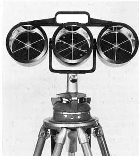
1 *DM 1000 auf Zentrierstativ. Das auf das Instrumente aufgesetzte Gehäuse enthält Batterie und Ladegerät.*
