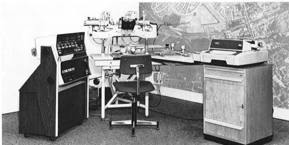
Auswertegerät PG 2 mit elektronischer Modellkoordinatenregistrierung
