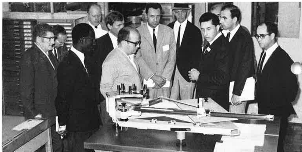
Oben: Herr H. G. Naumann erklärt die Prüfung des PG 2-Pantographen Rechts: Herr F. Hinder demonstriert die Rundlaufprüfung einer DKM 3-Horizontalachse
