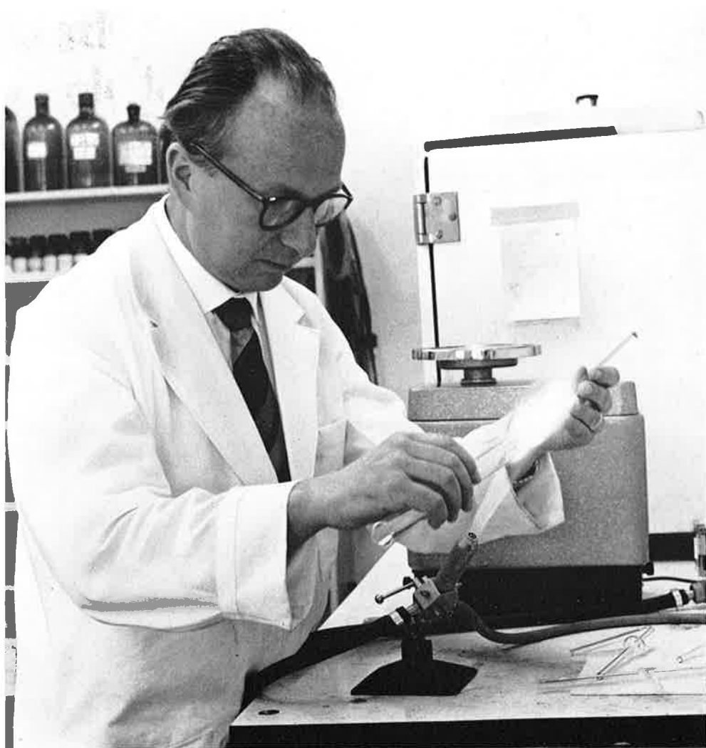
1 Durchführung einer chemischen Reaktion in einer Glas-Apparatur 2 Zusammenschweißen von Glasteilen in der Gebläseflamme
