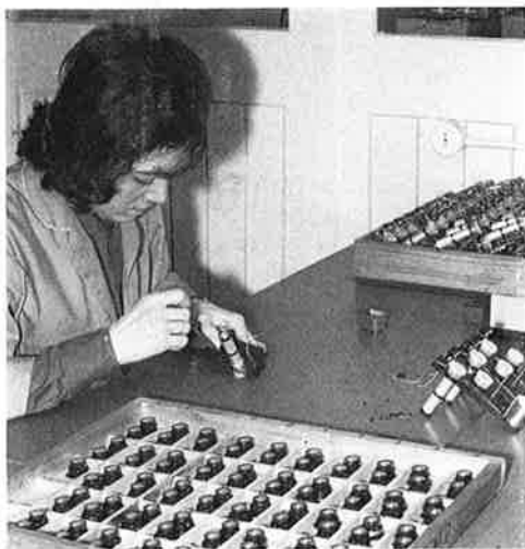
Montage von Motor, Zwischenrädern und Schalter für das Kino-Objektiv Vario-Switar
