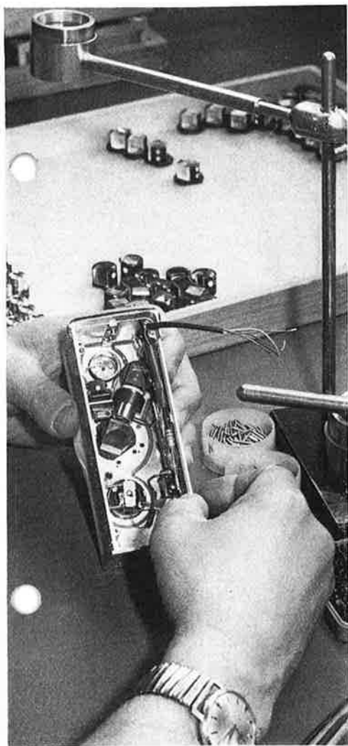
Einbau von Automatik, Meßwerk und Prismen in die Gehäuse der Kino-Objektive Vario-Switar
