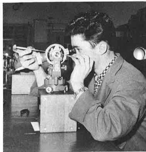
Montage eines Vermessungsinstrumentes
