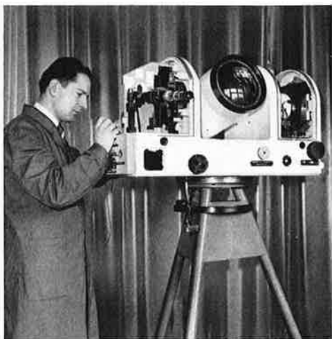
Justierarbeiten an Kinotheodolit EOTS
