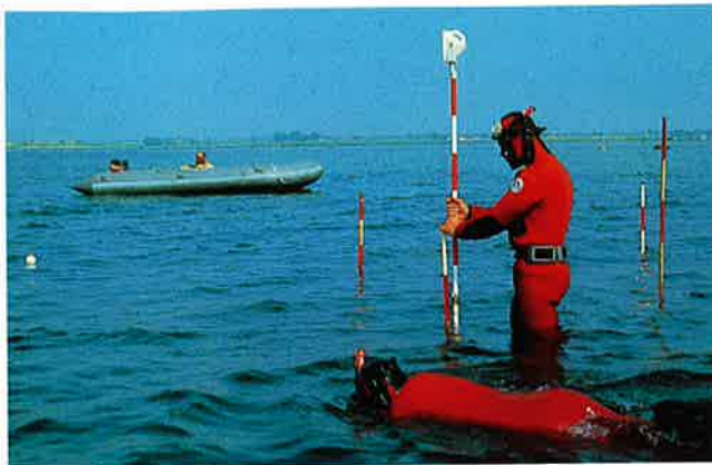
1 Ungewöhnlicher Standort eines Kern Reflektors zur Aufnahme des Schiffswracks (Foto: P-O Källgren).
