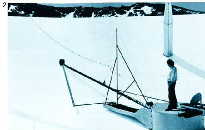
1 Prinzip der Reflektormessung. Der Theodolit ist im Scheitelpunkt des Paraboloids aufgestellt. THA: Theodolitachse, R: Arm (Rohr), CC: Tripelprisma, S: Paraboloidspiegel.
