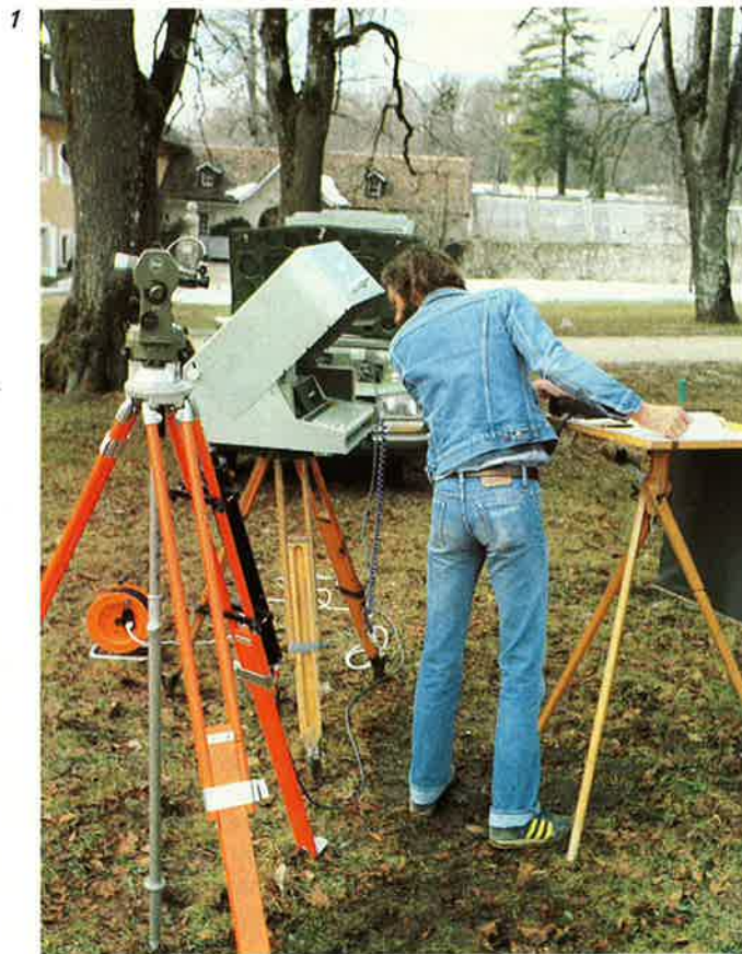
1 K1-M mit Laserokular-Ausrüstung; daneben ein an einem Generator angeschlossener Rechner HP-85.
