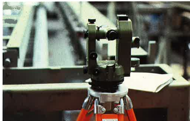
1 Zum Ausrichten der Schienen wurde ein Bautheodolit Kern K 0-S verwendet.
