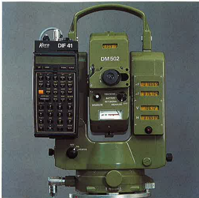
Dateninterface DIF 41, angeschlossen am elektronischen Theodolit E1 mit aufgesetztem Distanzmesser DM 502
