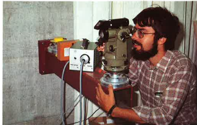
3 Beleuchtungseinrichtung der Rubinzielmarken. Eine handelsübliche Kaltlichtquelle erzeugt einen hellen Lichtstrahl, der über einen flexiblen Glasfaser-Lichtleiter in den Fernrohraufsatz des DKM2-A geführt wird. Durch ein Umlenkprismensystem gelangt das Lichtbündel objektivseitig auf einen exzentrisch zur Zielachse montierten kippbaren Spiegel.
