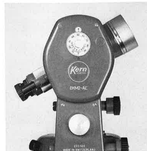
Abb. 1 Rändelschraube des Kippachsmikrometers mit Skala am Deckel des Höhenkreisgehäuses
