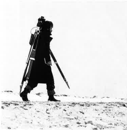
Abb. 3 Beim Stationswechsel zu Fuss kann die gesamte Ausrüstung auf dem Stativ belassen und von einer Person mühelos getragen werden.
