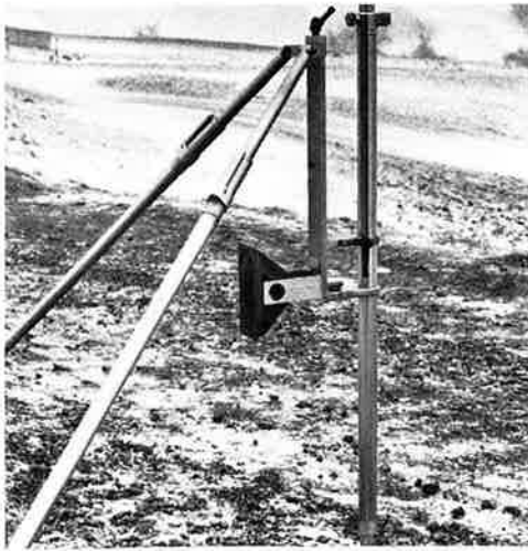
Abb. 5 Mit dem universellen Reflektorstativ ist auch eine solche Reflektoraufstellung ( 20 < z < 90 cm) möglich.
