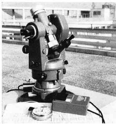
Abb. 2 Messbereiter DKM 2-A auf der Terrasse der Technischen Hochschule Wien (Pfeilerstation)
