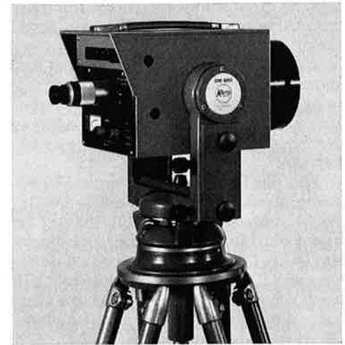
Abb.1 Der messbereite Kern DM 1000 auf dem Zentrierstativ
