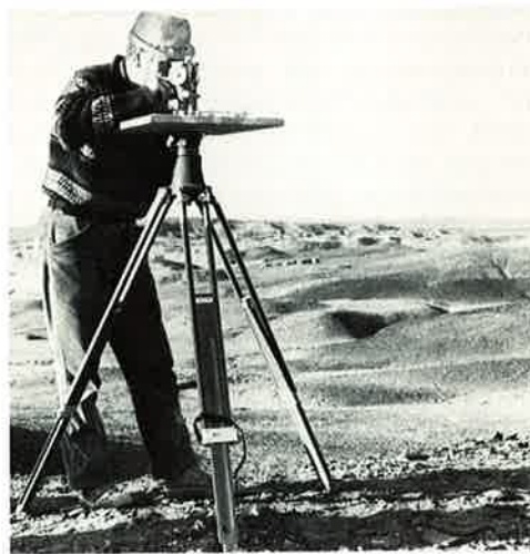
Abb. 4 Der Verfasser bei der Geländeaufnahme mit einer Kern-Kippregel RK
