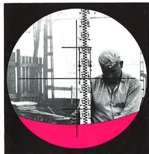
Abb. 6 Warnblende im Fernrohrgesichtsfeld des GKO-A bei ungenügend horizontiertem Instrument
