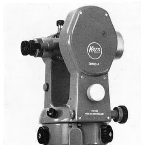
Abb.4 Die weitgehend digitalisierte Kreisablesung des DKM 2-A
