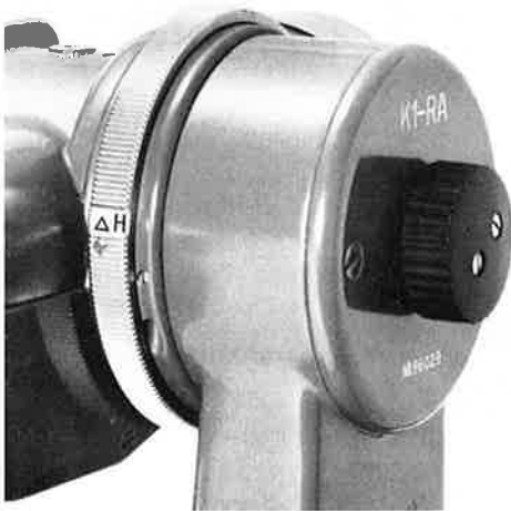
Abb. 3 Die Umschaltung von Horizontaldistanz- auf Höhendifferenz-Ablesung erfolgt mit dem randrierten Ring.
