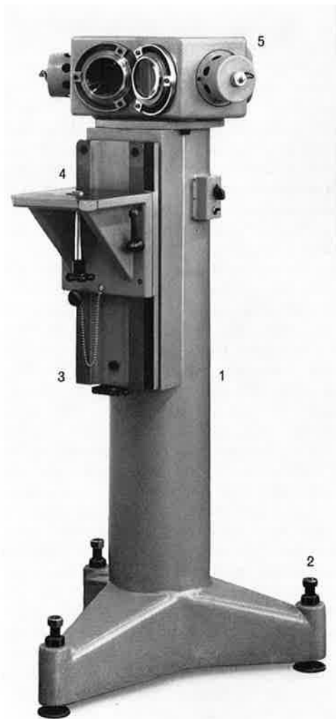
1 Aufbau des Winkelkollimators. 1 Tragsäule, 2 Horizontalierschraube mit Gegenmutter und Fußplatte, 3 Schwalbenschwanzführung, 4 Tisch, 5 Kollimatorgehäuse.
