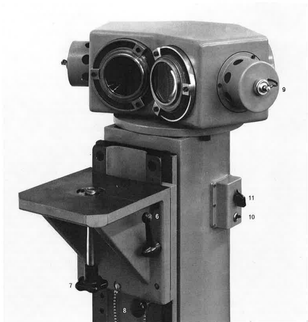
2 Details des Winkelkollimators. 6 Klemmhebel, 7 Anzugschraube, 8 Sicherungstift, 9 Beleuchtungslampen der Kollimatoren, 10 Schalter für Beleuchtung, 11 Regulierwiderstand für Beleuchtung.
