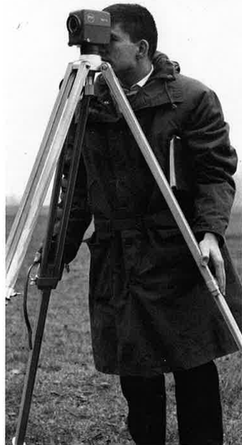
3 Stativschwingungen werden durch leichtes Anfassen der Stativbeine zum Abklingen gebracht.
