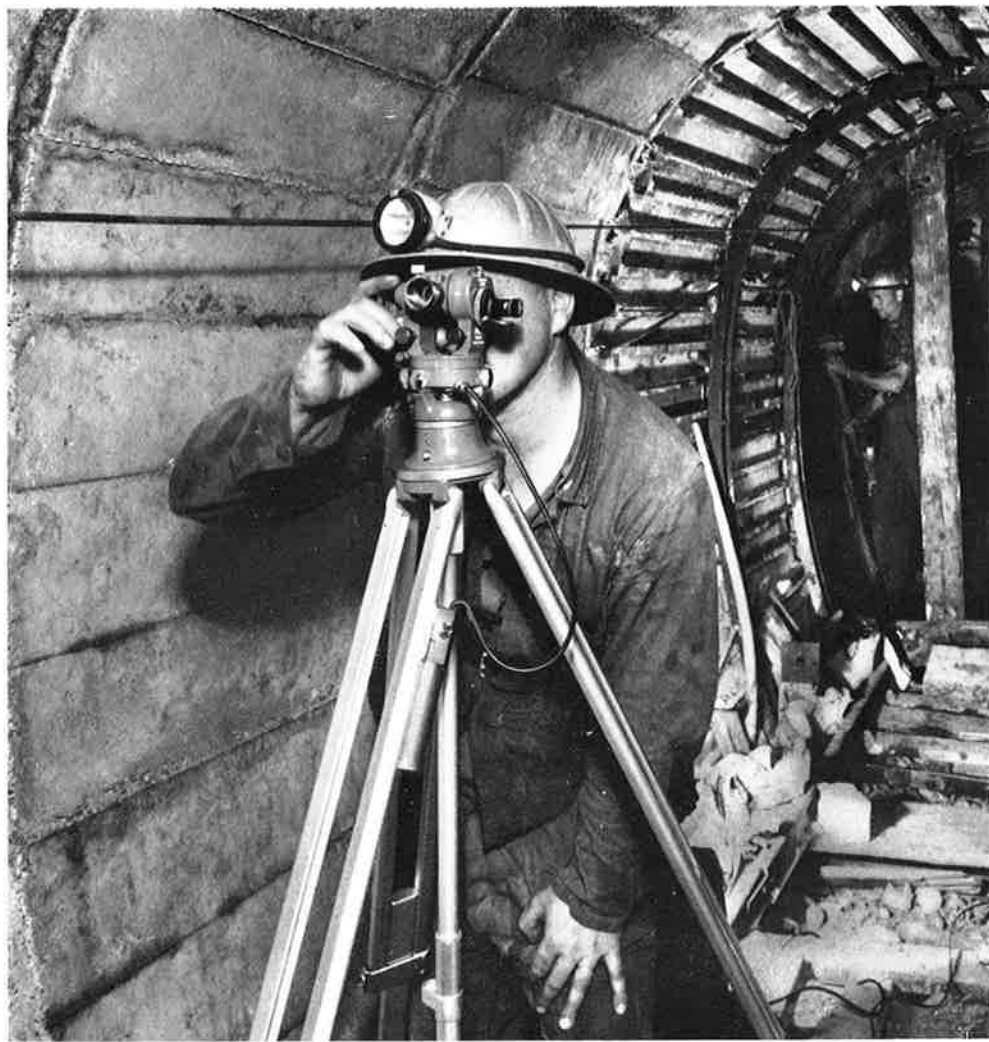
Kern-DKM 1 mit elektrischer Beleuchtung auf Zentrierstativ bei der Stollenabsteckung.
