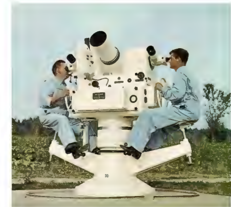
Kino-Theodolit EOTS von Kern für die Firma Contraves (Zürich). Er diente der Vermessung der Flugbahn von Geschossen und Raketen. Werbefoto, undatiert.
