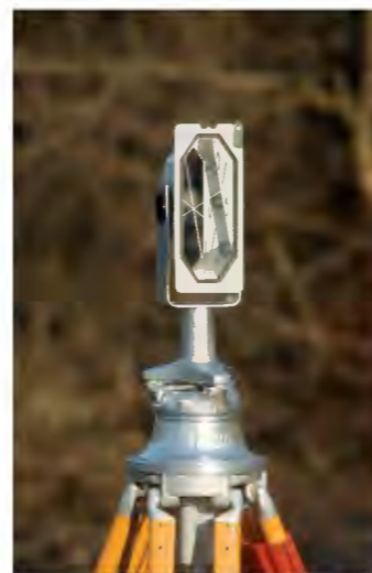
Reflektoren für die elektro-optische Distanzmessung. Diese stehen im Streckenendpunkt und reflektieren das Infrarotsignal.
