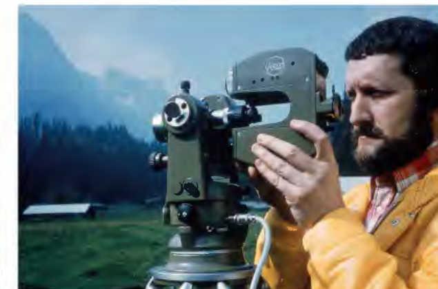
Distanzmesser DM 500 (1974). Der damals kleinste, auf Theodolite aufsteckbare elektronische Entfernungsmesser (hier auf einem DKM2-A). Sende- und Empfangsoptik befinden sich hinter zwei getrennten Objektiven.
