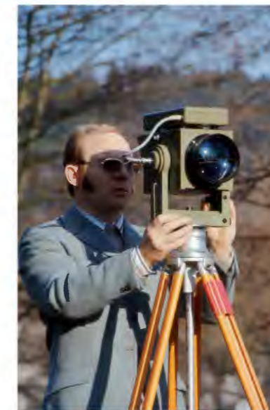
Distanzmesser DM 500 (1974). Der damals kleinste, auf Theodolite aufsteckbare elektronische Entfernungsmesser (hier auf einem DKM2-A). Sende- und Empfangsoptik befinden sich hinter zwei getrennten Objektiven.
