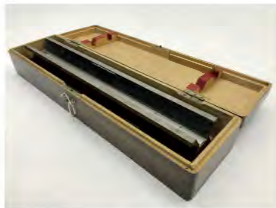
500mm-Längennormal, Querschnitt des Urmeters von Paris um 1900.
