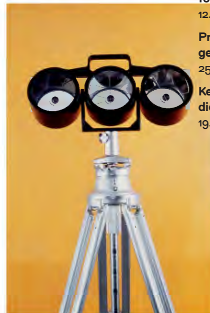
Reflektoren für die elektro-optische Distanzmessung. Diese stehen im Streckenendpunkt und reflektieren das Infrarotsignal.
